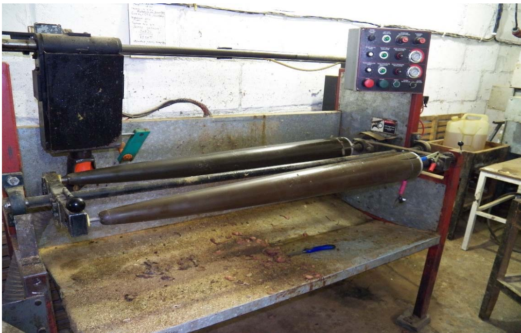
Рис. 2. Станок для зняття жиру зі шкурок
